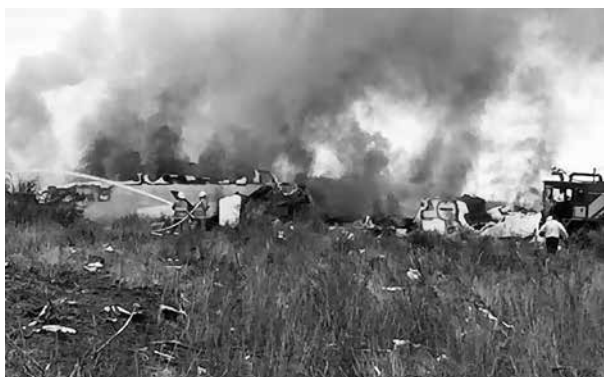
圖1、2018年墨西哥航空從杜蘭戈機場起飛後遭遇微爆氣流的強風切造成飛機失速，撞上跑道外停機坪
