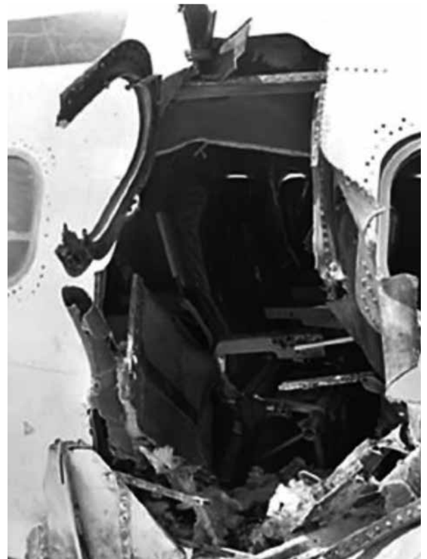
D3 159 航機明顯由內向外之爆炸痕跡，證明爆裂物位於客艙內 照片來源 Ministry of Transport and Civil Aviation of Federal Republic of Somalia
